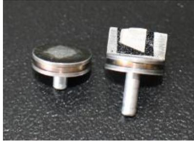
图 1 常用的扫描电镜样品台
